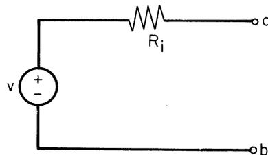
en este caso se tiene una fuente de voltaje real, ya que si se conecta entre las terminales de la fuente a y b una resistencia de valor cero la corriente que fluye a través de ésta es:
