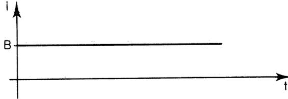
Las fuentes de corriente descritas son fuentes de corriente ideales, debido a que si se conecta entre sus terminales una resistencia de un valor muy grande el voltaje a través de ésta será muy grande, lo cual es imposible desde el punto de vista práctico; para solucionar este problema se conecta una resistencia de valor finito en paralelo con la fuente, teniendo así una fuente de corriente real, esto es:
