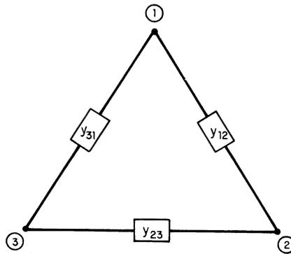
El teorema establece que si se tiene un sistema eléctrico con  $n$  fuentes de voltaje  $V_1, V_2, V_3, \dots, V_n$  con admitancias internas  $Y_1, Y_2, Y_3, \dots, Y_n$  respectivamente y están conectados en paralelo como se muestra en la figura:
