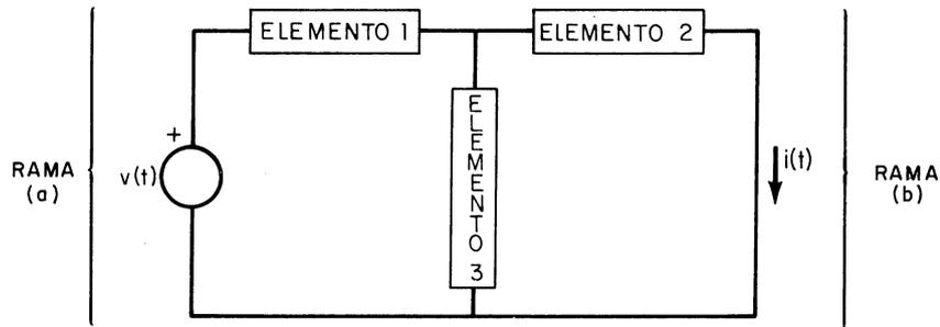
El teorema de reciprocidad establece que al aplicar un voltaje externo  $v(t)$  a cualquier rama del sistema eléctrico bilateral, éste producirá una cierta corriente  $i(t)$  en cualquier otra rama del sistema (véase la figura anterior), si el voltaje externo  $v(t)$  se aplica a la rama (b) del sistema, éste producirá la misma corriente  $i(t)$  en la rama (a) (véase la figura siguiente):
