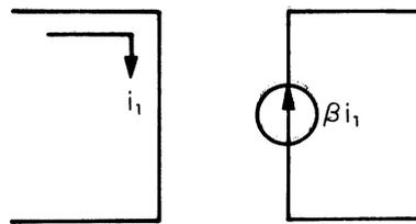
Este tipo de fuentes frecuentemente se usan para modelar y/o representar elementos eléctricos más complejos (diodos, transistores, amplificadores, rectificadores controlados de silicio, varactores, etc.).
