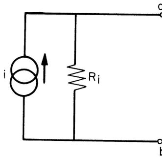
en este caso el voltaje entre las terminales a y b de la fuente en el mejor de los casos, es decir, cuando se conecta una resistencia de valor infinito entre las terminales a y b será:
