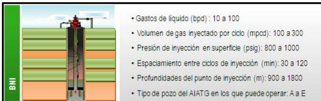
Figura 2.35 Especificaciones del BNI aplicado en el AIATG.<sup>1</sup>
