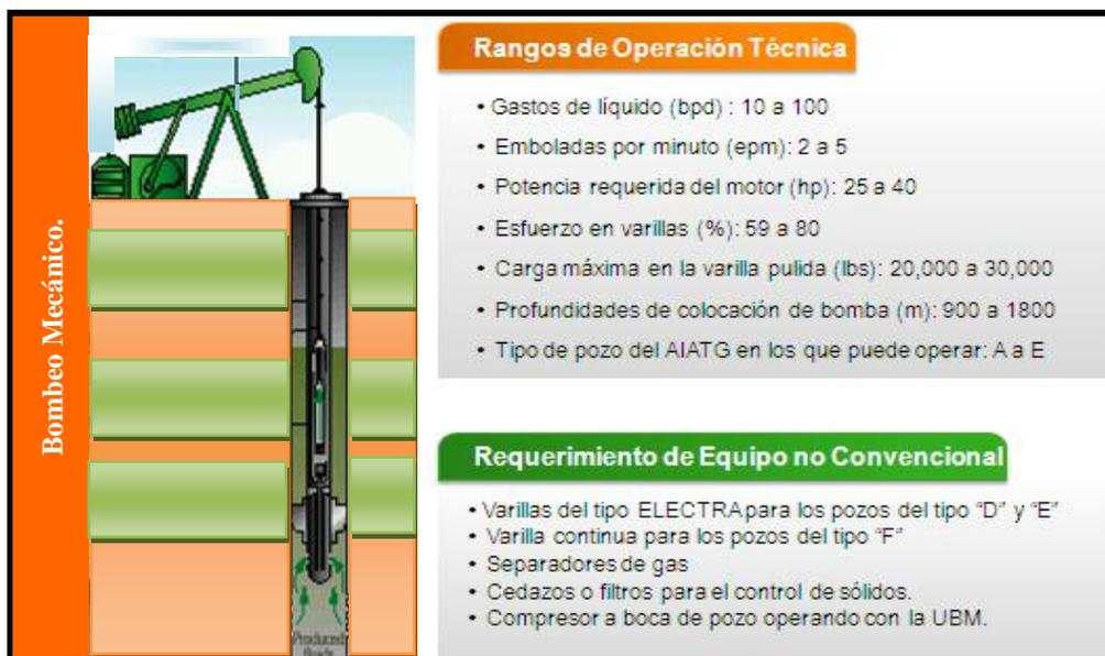
Figura 2.22 Especificaciones del BM aplicado en el AIATG.<sup>1</sup>
