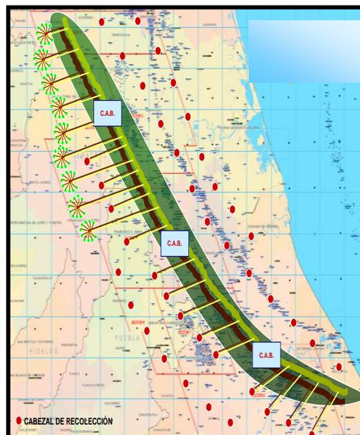
Figura 4.7 Cabezales de recolección y macro-derecho de vía para campos del AIATG. <sup>1</sup>
