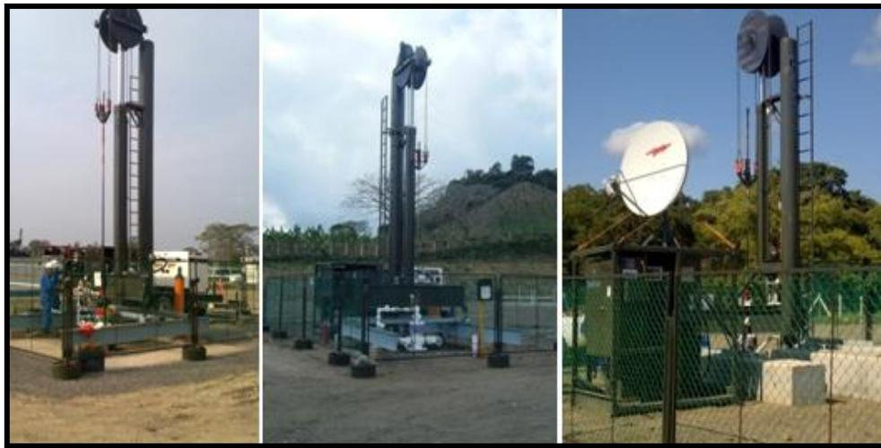
Figura 2.31 Unidad de Bombeo Hidroneumático Dynapump.<sup>9</sup>
