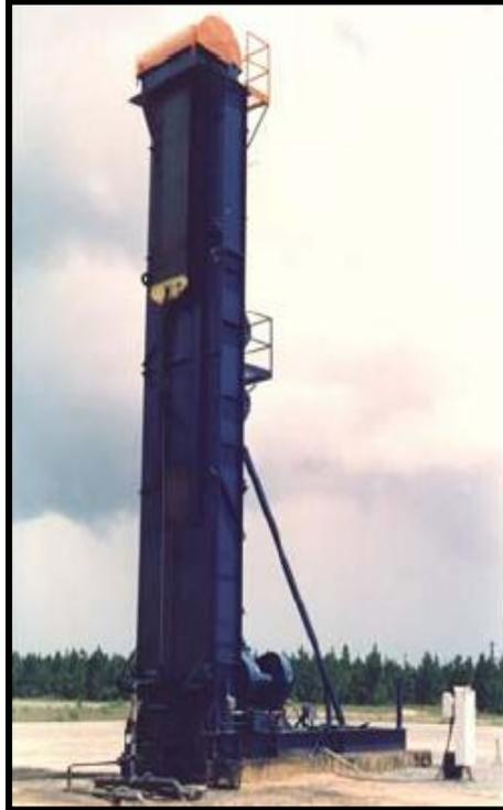
Figura 2.26 Unidad de carrera extra-larga Rotaflex. <sup>13</sup>
