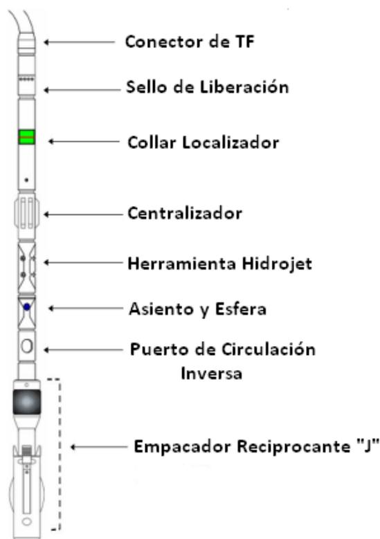
FIGURA 3.5.- Equipo de fondo del método HPAP.<sup>18</sup>
