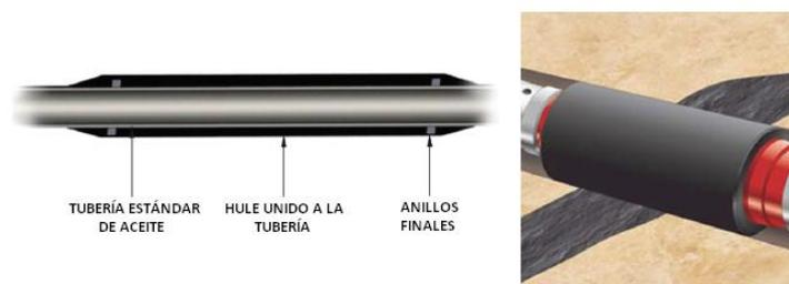
FIGURA 3.8.-. Componentes de un empacador inflable.<sup>26</sup>
