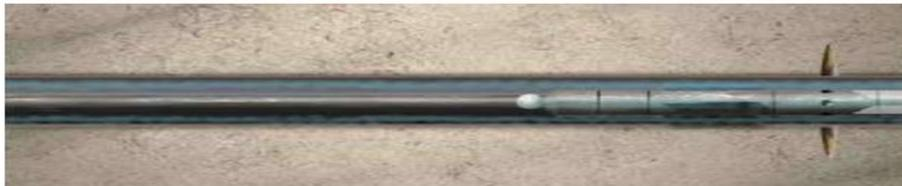
FIGURA 3.11.- Circulación inversa de la esfera hacia superficie, dejando abierta la tubería.<sup>26</sup>
