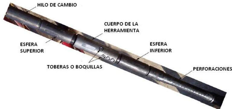
FIGURA 3.3.- Sección de una herramienta lista para entrar al pozo para un tratamiento con HJAF.<sup>26</sup>
