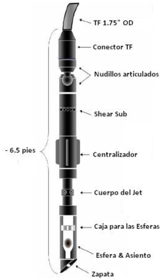
FIGURA 3.4.- Equipo de fondo del método HPAP con PPD.<sup>11</sup>
