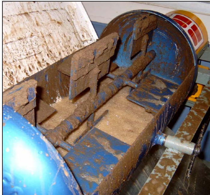
Figura III.15. Lavado de suelo mecánico con tensoactivo.
