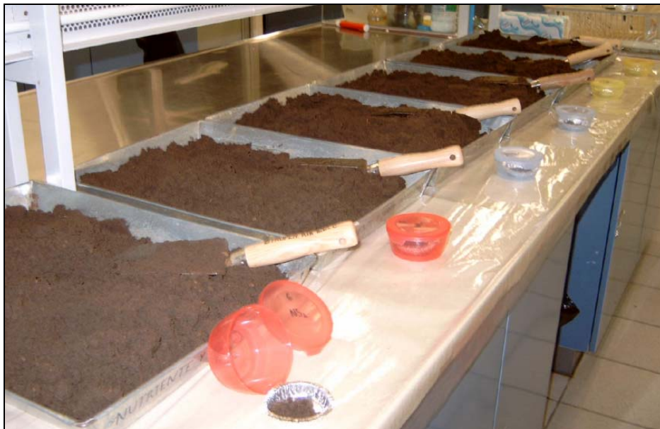
Figura III.9. Unidades experimentales de tratamientos biológicos (atenuación natural, biorremediación con nutrimentos y biorremediación con nutrimentos-tensoactivo).
