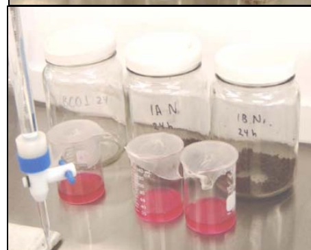
Figura III.11. Determinación de la actividad microbiana por respirometría (CO 2 ) (Alef, 1998).
