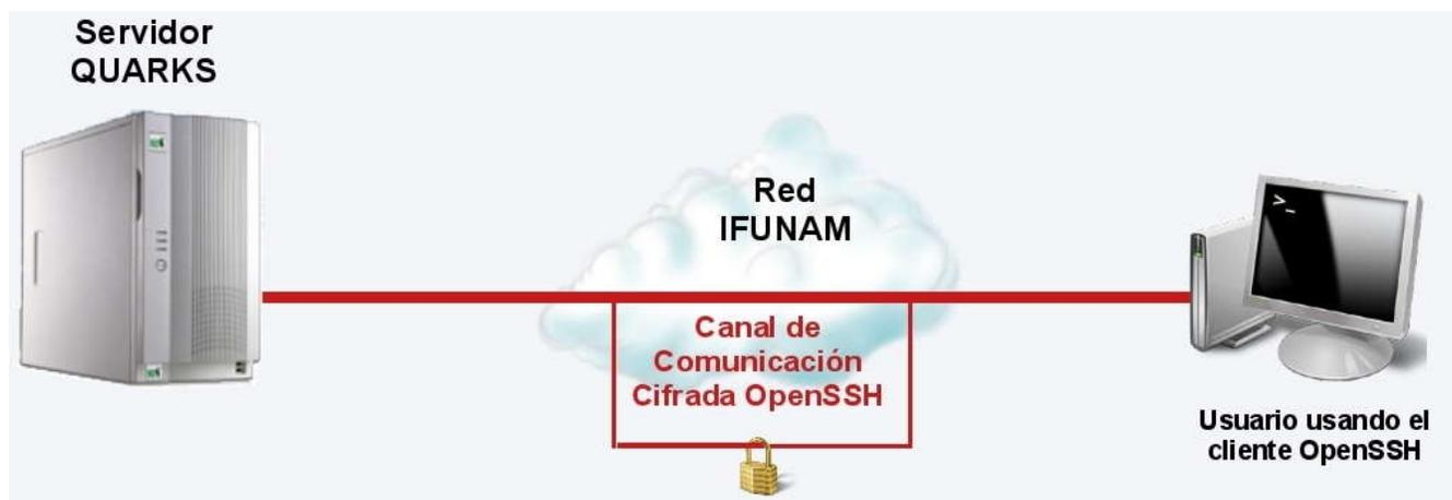
Figura 2.7 Ejemplo de conexión usando el protocolo SSH
