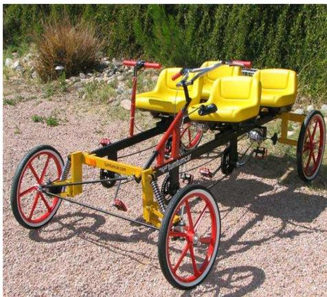
Imagen 2.5. El *Tumtumcar V4* posee sistema de amortiguamiento independiente con la opción de ser híbrido en su transmisión de potencia.<sup>26</sup>
