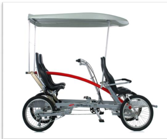
Imagen 2.1. Cuatriciclo 2 - *Rider* de 4 Plazas y estructura de aluminio.<sup>1</sup>
