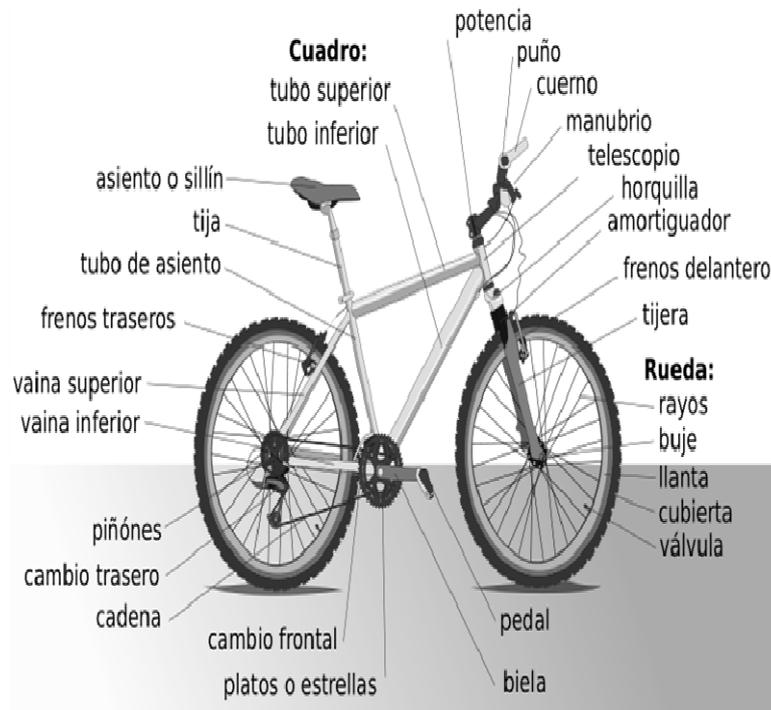
Imagen 1.6. Componentes generales de una bicicleta.<sup>7</sup>
