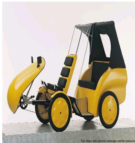
Imagen 1.18. El *AVD Taxi* ofrece un diseño aerodinámico y protección contra el clima de sus ocupantes.<sup>19</sup>
