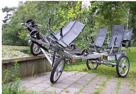
Imagen 2.17. Diferentes vistas del modelo de cuadriciclo *Quattrocycle*, el cual es el único en flexionarse de esa forma.<sup>12</sup>
