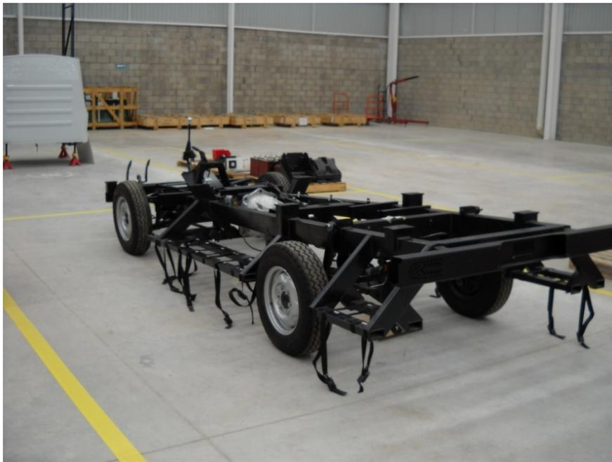
En la imagen se puede ver el diferencial ensamblado al bastidor con ayuda del dispositivo de ensamble.
