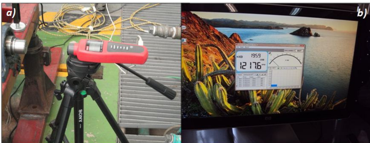
Figura 3.5. a) Tacómetro digital, b) Registro de rpm.
