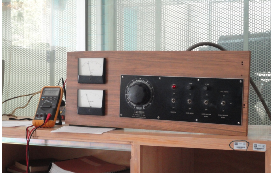
Figura 3.4. Suministro de corriente mediante el reóstato.
