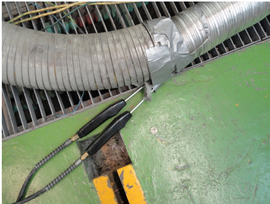
Figura 3.10. Sondas de muestreo para emisiones y material particulado.
