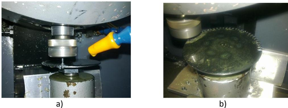
Figura 4.10 Fabricación del disco *encoder*.
