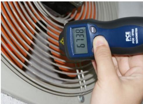
Figura 3.15 Tacómetro óptico reflectivo
