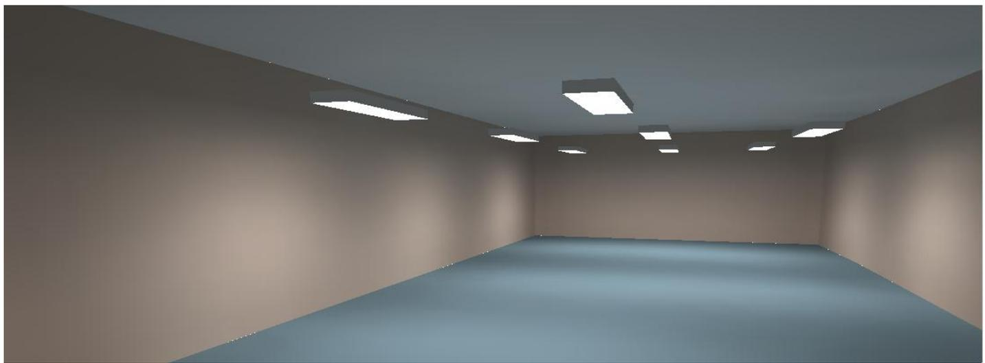
Figura.- 40 esta es la vista de iluminación en 3D de tienda escuela con 8 luminarias de 2X32W de gabinete sencillo, donde se puede ver perfectamente iluminada, con parámetros dentro de norma.
