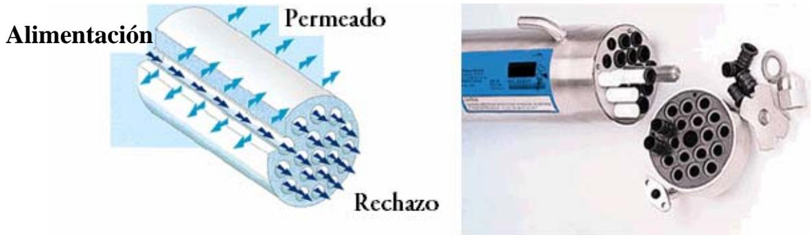
Figura 0-2. Membrana tubular
