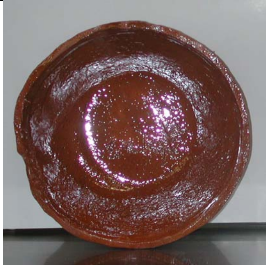
Figura 4.6. Pieza elaborada con 50% de lodo de tarquina y 50% de barro tradicional.
