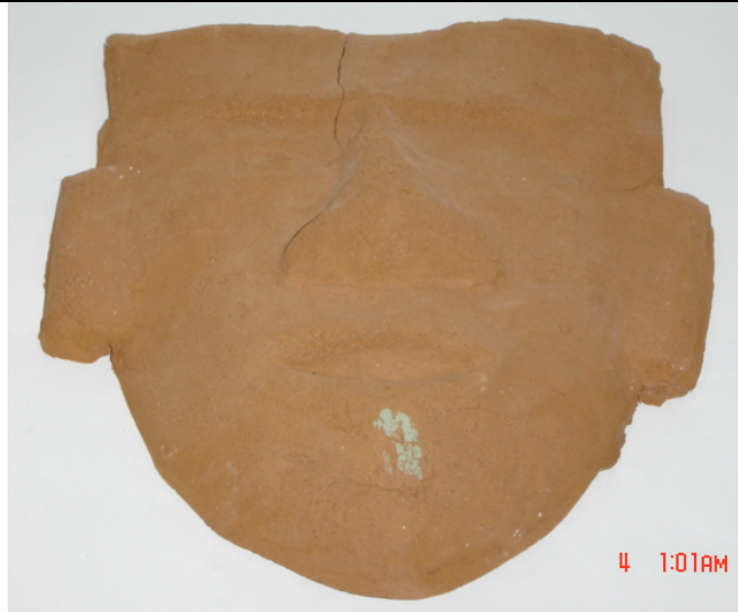
Figura 4.8. Pieza de mayor tamaño elaborada con 50% de lodo y 50% de barro tradicional.
