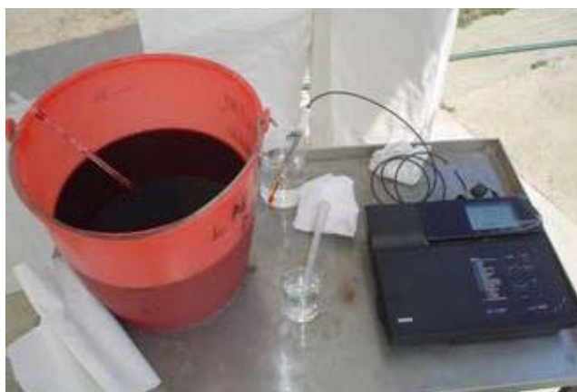
Figura 3.6. Ajuste del pH en el lixiviado
