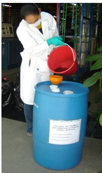
Figura 3.2. Recipiente de 100 litros donde se almacenaron los lixiviados en un cuarto frío a 4°C
