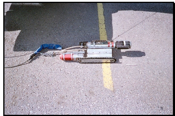
Cámara móvil con desplazamiento a través de oruga, con lente (lado derecho) de giro de hasta 360 °. Obsérvese la pluma en el pavimento al lado derecho de la cámara para tener una dimensión de esta
