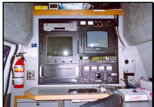
Interior de la camioneta Van, en donde se observa el monitor de video para el seguimiento del recorrido en tiempo real de la cámara. La toma de video es comúnmente grabada en una cinta de video VHS
