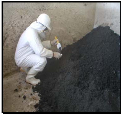
Figura V.16. Muestreo aleatorio estratificado del lodo estabilizado
