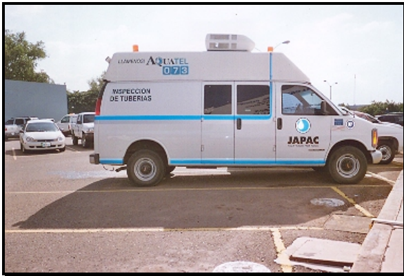
Camioneta Van equipada con cámara móvil para la inspección de tuberías para drenaje o agua potable
