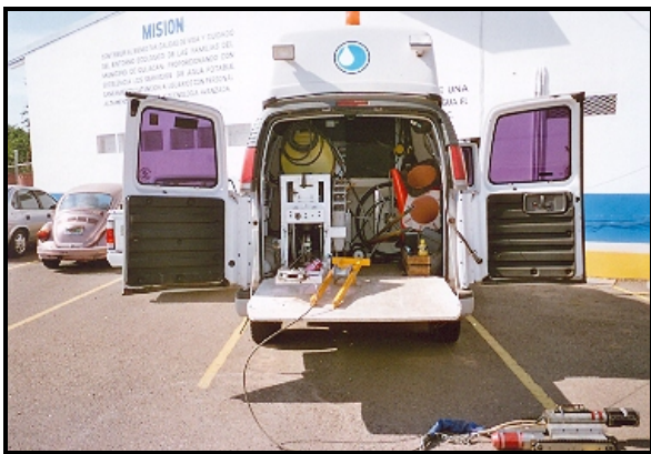
La camioneta cuenta con equipo de respiración autónoma, sonda o cable de acero, contador de la distancia recorrida por la cámara móvil y monitor de video entre otras cosas
