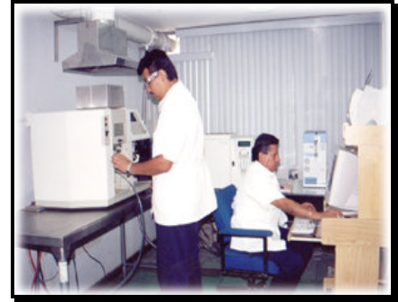
Figura IV.10. Espectrofotómetro de absorción atómica, para la determinación de metales pesados
