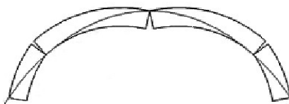
Figura 3.4 Mecanismo de falla de un arco semicircular simétrico
