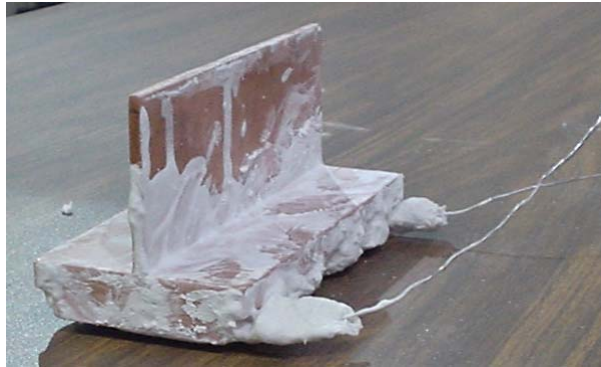
Figura 2.4 Colocación de resistencia eléctrica
