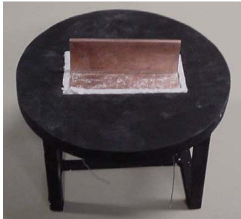
Figura 2.5 Fijación de la aleta sobre una base
