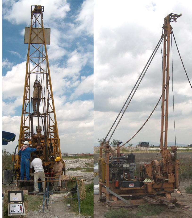
Figura 2.4. Equipo de hincado de cono eléctrico
