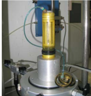
FIGURA 2.12. Probeta en la que se aprecia el papel filtro y la membrana de látex.
