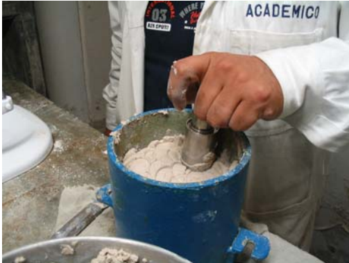
(a) Apisonamiento del material en capas.
