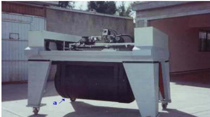
Figura A.9: Tanque pulmonar de 300 l para mantener el vacío.
