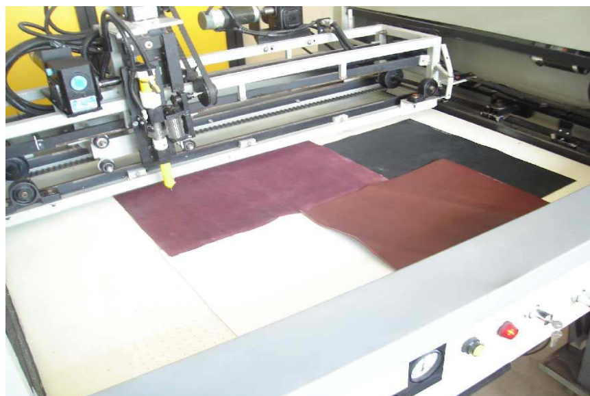
Figura A.12: Area de trabajo del robot cartesiano.
