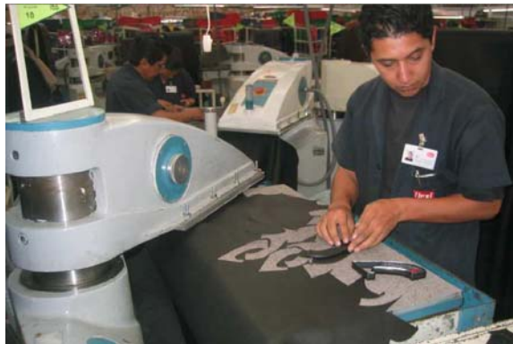
Figura 1.2: Prensa hidráulica de golpe o suajadora.
