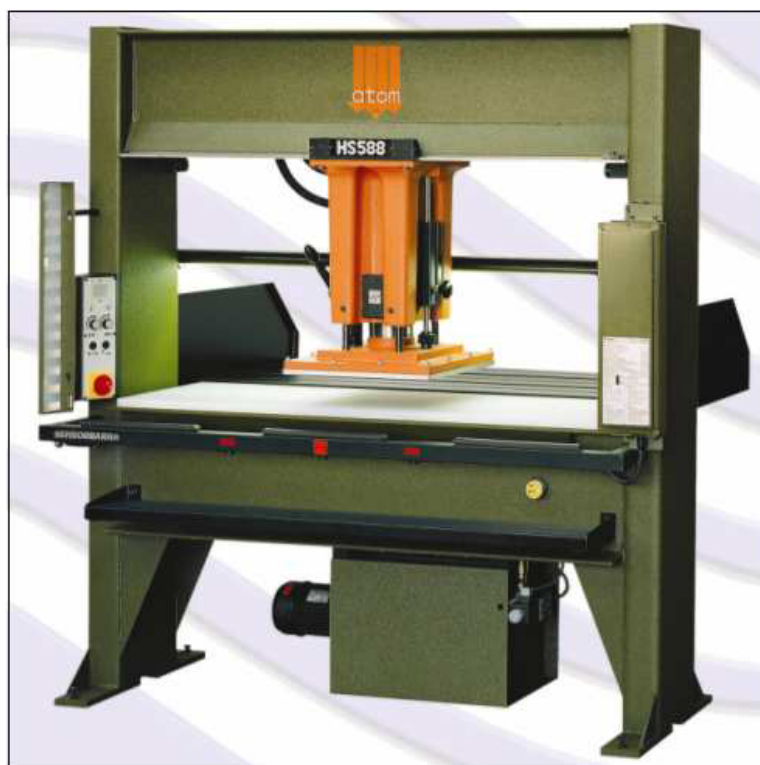
Figura 1.9: Máquina hidráulica de puente, área de trabajo 1.6 m x 50 cm, peso 1700 kg.
