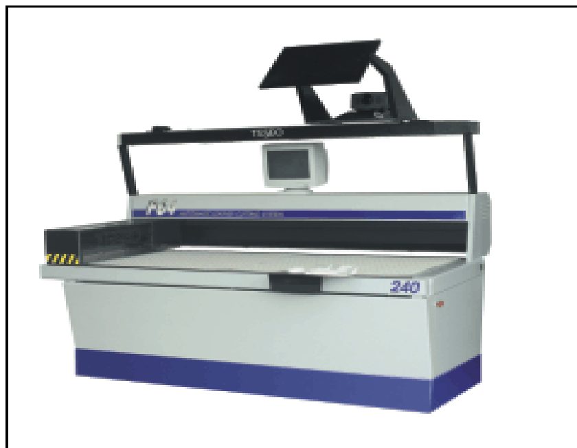
Figura 1.14: Máquina FC4240. Área útil: 2400 x 1000 mm. Velocidad: 60 cm/seg. Peso: 1400 Kg. Dimensión: 3.0 x 1.6 x 2.6 m.
