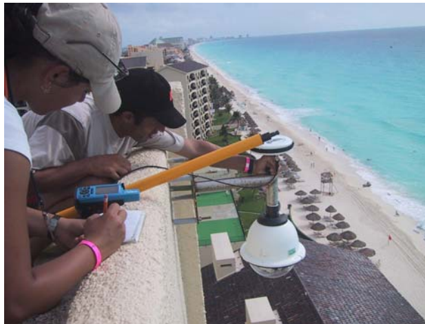
Figura 2. 8. Obtención de la posición de la cámara por medio del GPS
