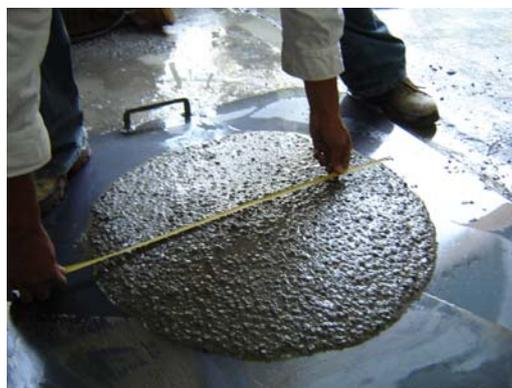
**Tabla 3. Criterio de aceptación para el concreto autocompactable**
