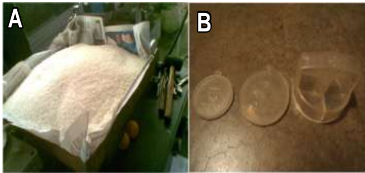
Ilustración 2. A) PLA natural antes de secar, B) Pruebas con PLA con distintos moldes del CDMIT para conocer propiedades
