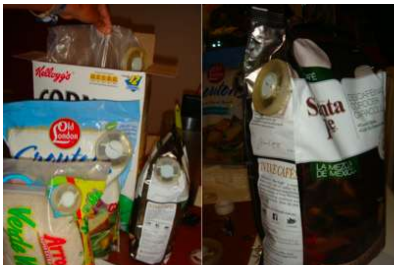
Ilustración 14. Pruebas de prototipos de diafragmas en distintas bolsas para granos y polvos
