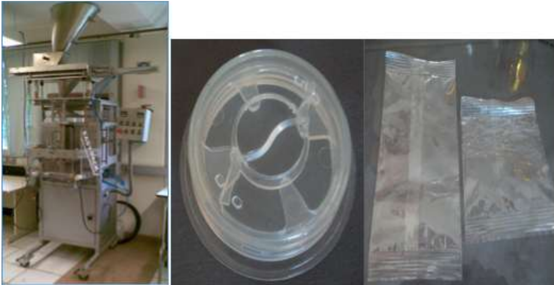
Ilustración 16. Máquina de Formado, Llenado y Sellado utilizada para el proyecto del lado izquierdo, la cual crea las bolsas de cómo las de la figura del lado derecho la cual será unida con los dispositivos de la figura del centro
