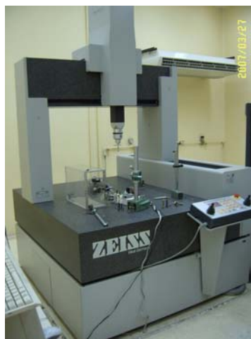
Figura 4.1 Máquina de medición de coordenadas marca ZEISS. Laboratorio de Metrología del CCADET, UNAM
