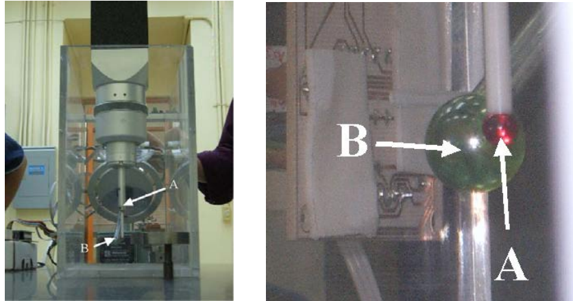
Figura 4.2 A) Punta del strain sauge de medición de la ZEIZZ, B) Esfera Instalada en la punta de la camisa del resectoscopio
