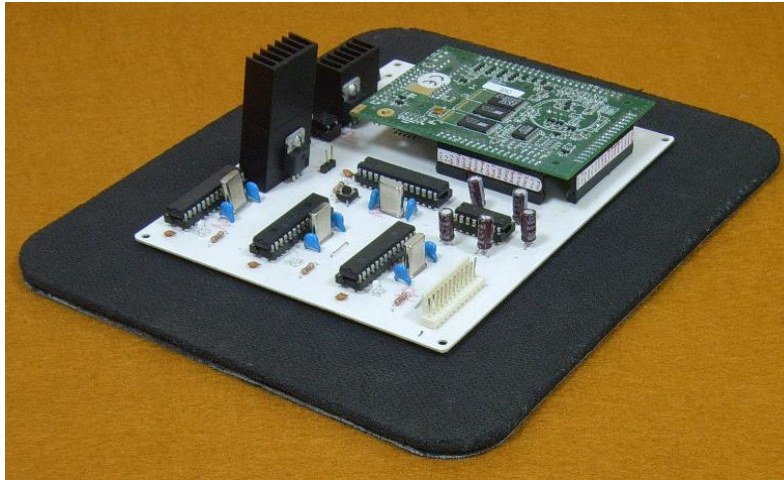
Figura 3.34 Placa de circuito impreso de los microcontroladores, fuentes de alimentación y comunicaciones.
