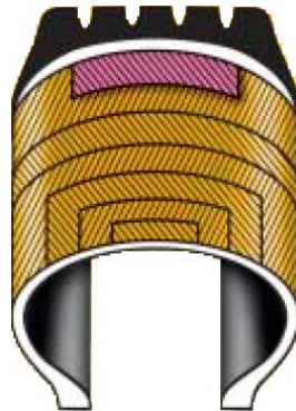
Figura A.3 Construcción convencional
