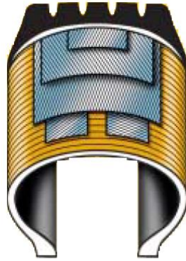
Figura A.2 Construcción radial
