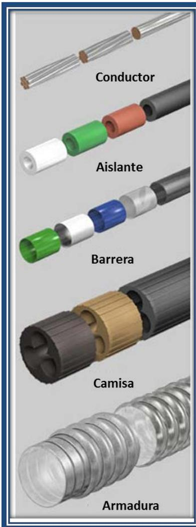
Figura II.11 Componentes del cable del BEC.
