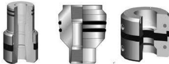
Fig. II. 9. Colgador de la tubería de producción.
