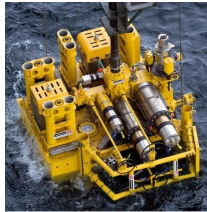
Fig. II. 17. Última generación de arboles mono bore (Propiedad de Cameron).
