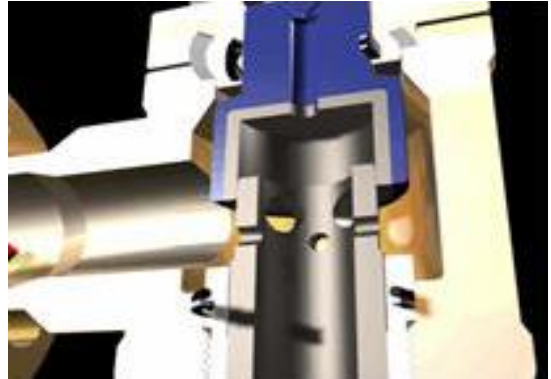
Fig. II. 6. Mecanismo Interno de un Estrangulador Submarino.
