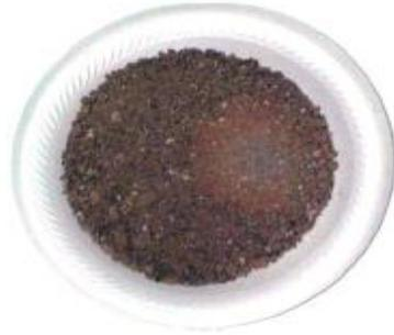
FIG. 3.7.1. b. Ejemplo de recortes que han sido procesados a través del secador de recortes. <sup>[24]</sup>
