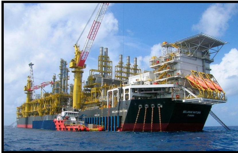
**Figura 3.9** Unidad Flotante de Producción, Almacenamiento y Descarga (FPSO). [www.iticompany.com]
