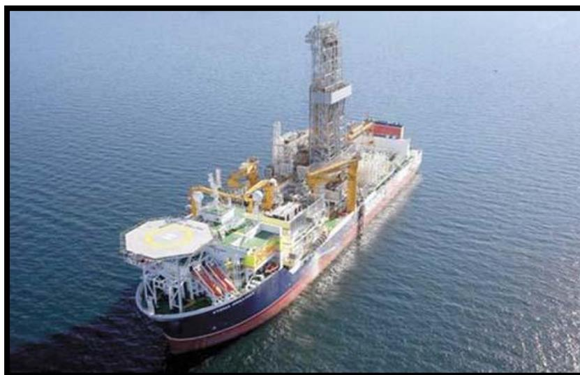
**Figura 3.8** Buque perforador británico Stena Drillmax. [British Petroleum]
