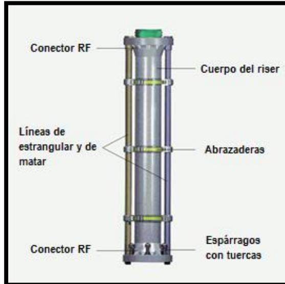
Figura 4.10 Tramo de riser con conectores y líneas de matar y estrangular. <sup>[104]</sup>
