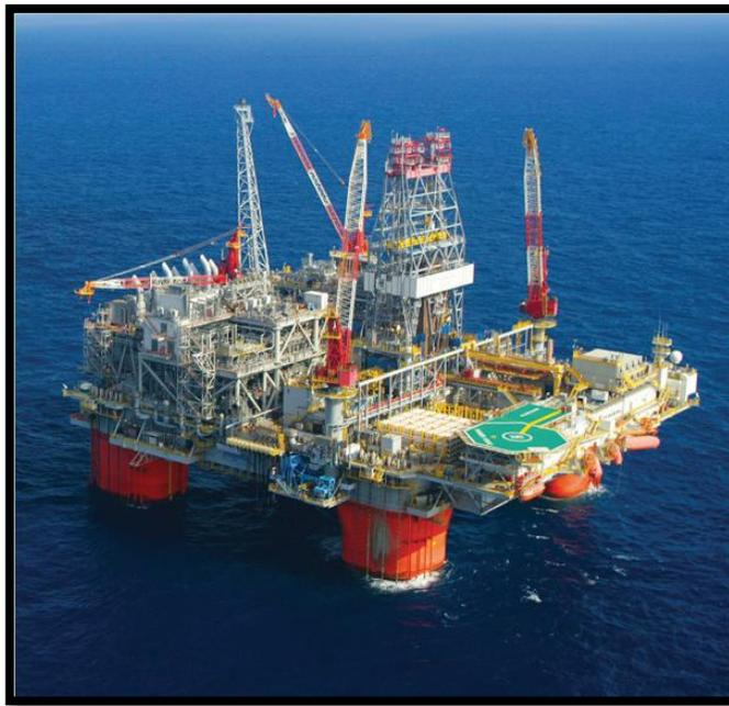
**Figura 3.2** Plataforma semisumergible.
