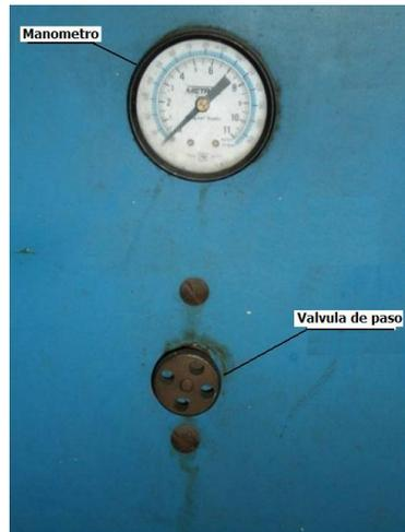
Figura 4.2.2.4.8 Manómetro para aire
