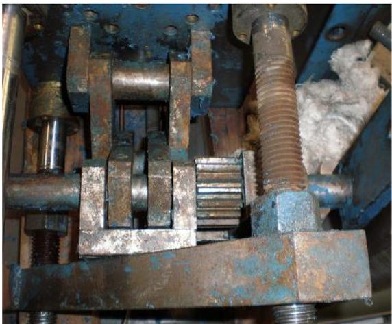
Figura 4.2.1.7 Sistema de cierre de la prensa
