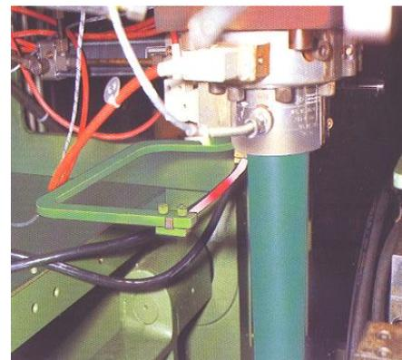
Figura 3.3.6.3 Sistema de corte por cuchillas calientes C C P; Cap. 2, La Máquina de Extrusión
