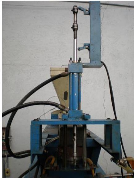
Figura 4.2.2.4.11 Pistón con boquilla sopladora
