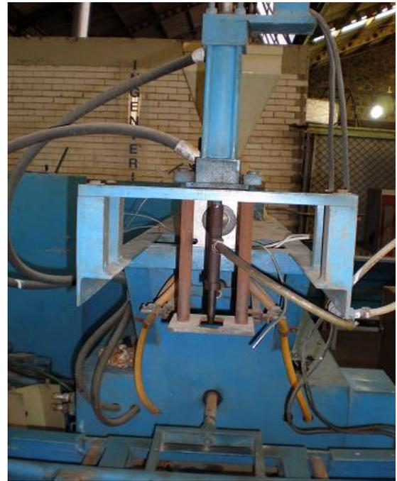
Figura 4.2.1.10 Vista del sistema de soplado
