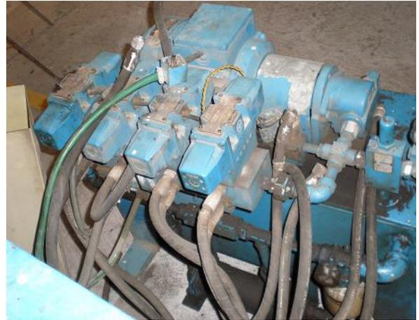
Figura 4.2.1.4 Electroválvulas de unidad hidráulica
