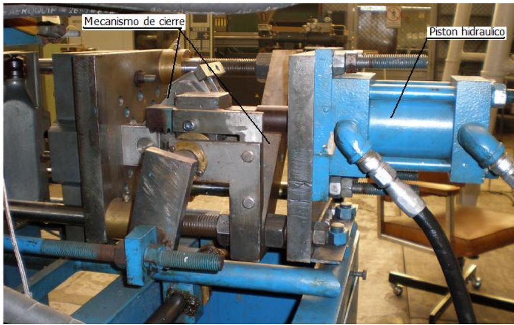
Figura 4.2.2.4.6 Mecanismo de cierre de la prensa
