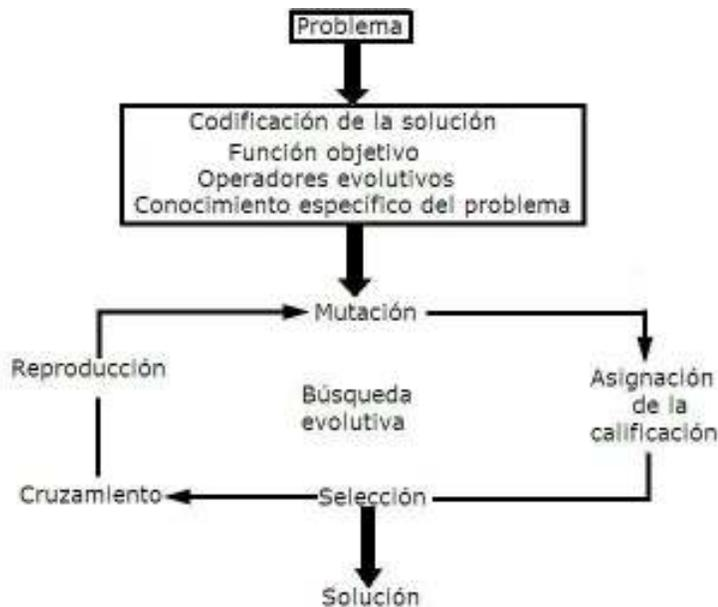
**Figura 3.1. Esquema de Funcionamiento de un Algoritmo Evolutivo**
