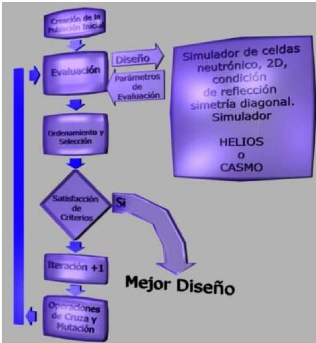
**Figura 4.3. Diagrama de flujo de la aplicación del Algoritmo Genético**
