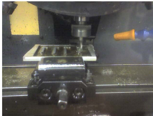
Figura 5.10: Fabricación de los mecanismos en la EMCO VMC-100
