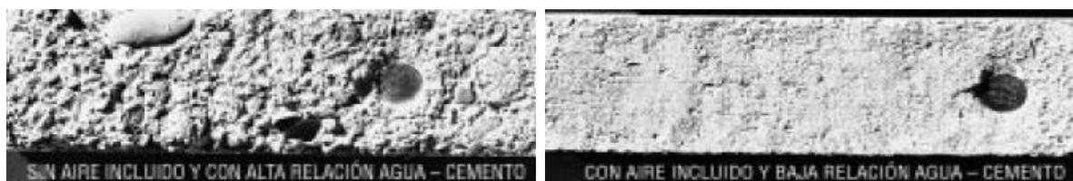
La ilustración muestra a los concretos normales con aire y sin aire incluido, donde el concreto con aire incluido es más resistente a repetidos ciclos de congelamiento y deshielo.<sup>8</sup>
