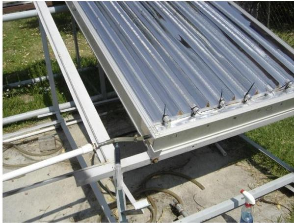
Fig.4.11. CPC con tubería de vidrio tipo boro-silicato.
