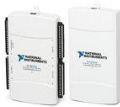
Fig.3.10. Tarjeta de adquisición de datos.
