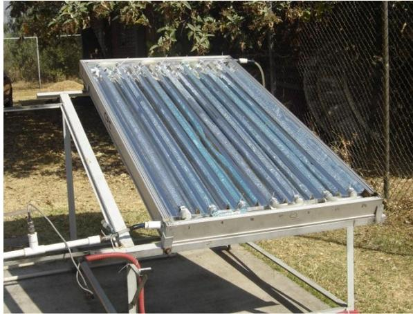
Fig.4.16. CPC con tubos de vidrio tipo boro-silicato de 25.4 [mm] de diámetro, esferas de 10 [mm] de diámetro y curvas de plástico.
