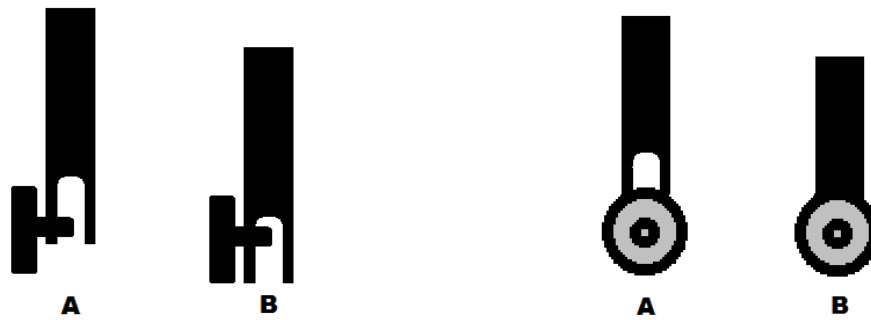
Fig. 64 Diagrama de funcionamiento de las ruedas de la 1° propuesta de andadera.
