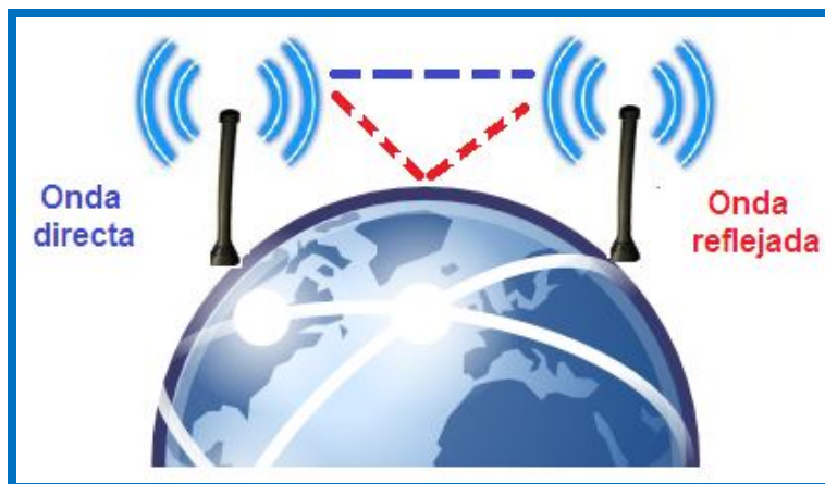
Figura 1.7 Enlace de microondas en línea de vista.
