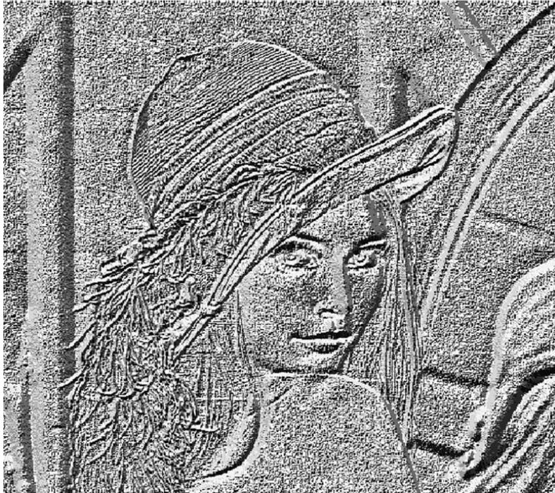
**Ilustración 1** Imagen obtenida al aplicar el algoritmo LBP a una imagen monoespectral
