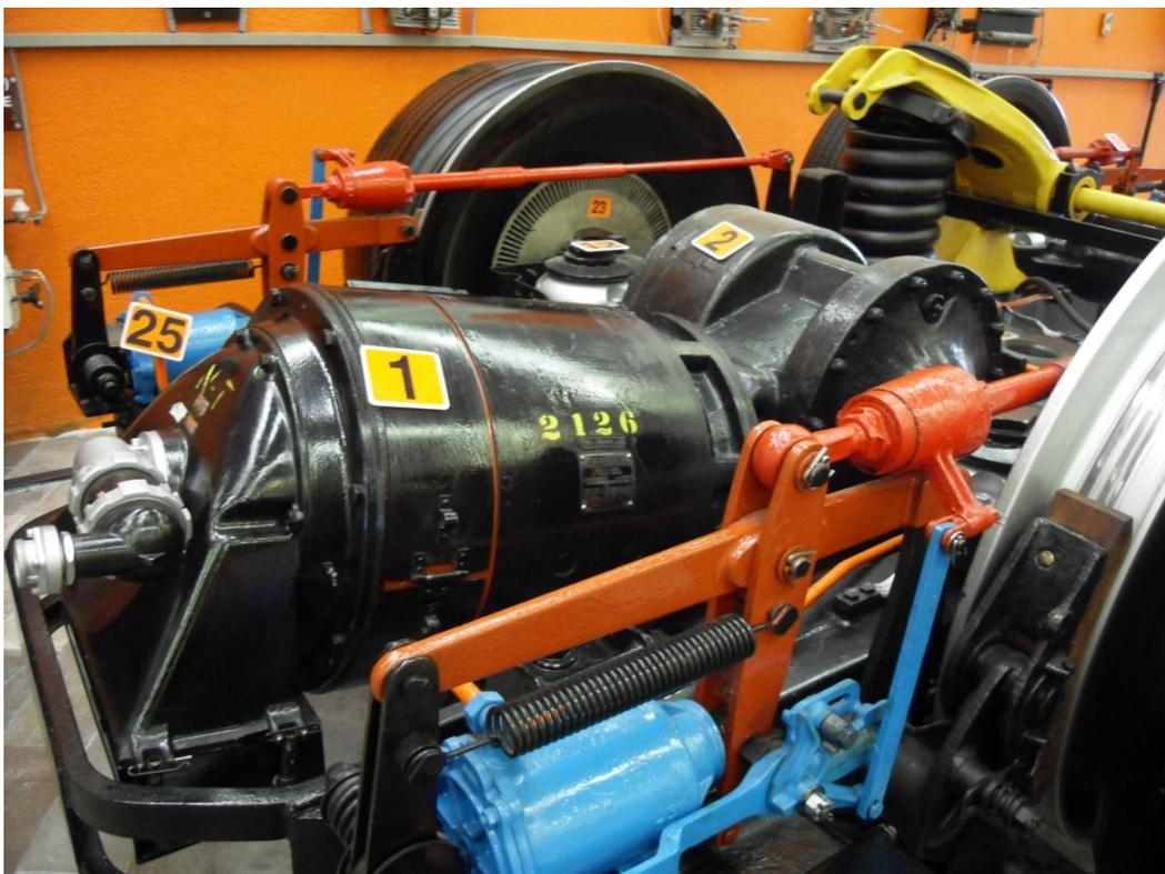
Figura 25. Motor de c.d. (1) de un vagón motriz sin cabina de la línea 3.
