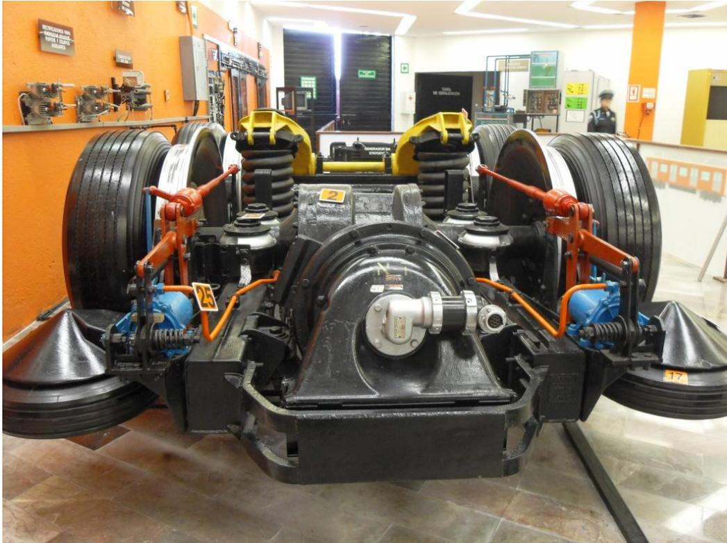
Figura 24. Bogue de un vagón motriz sin cabina de la línea 3.
