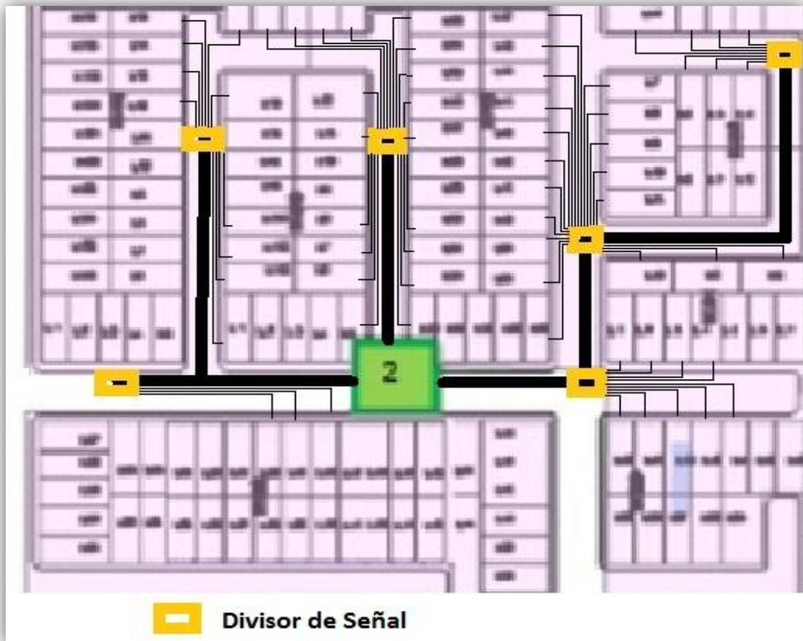
Figura 4.3.2.3 Ejemplo de distribución del cable coaxial.
