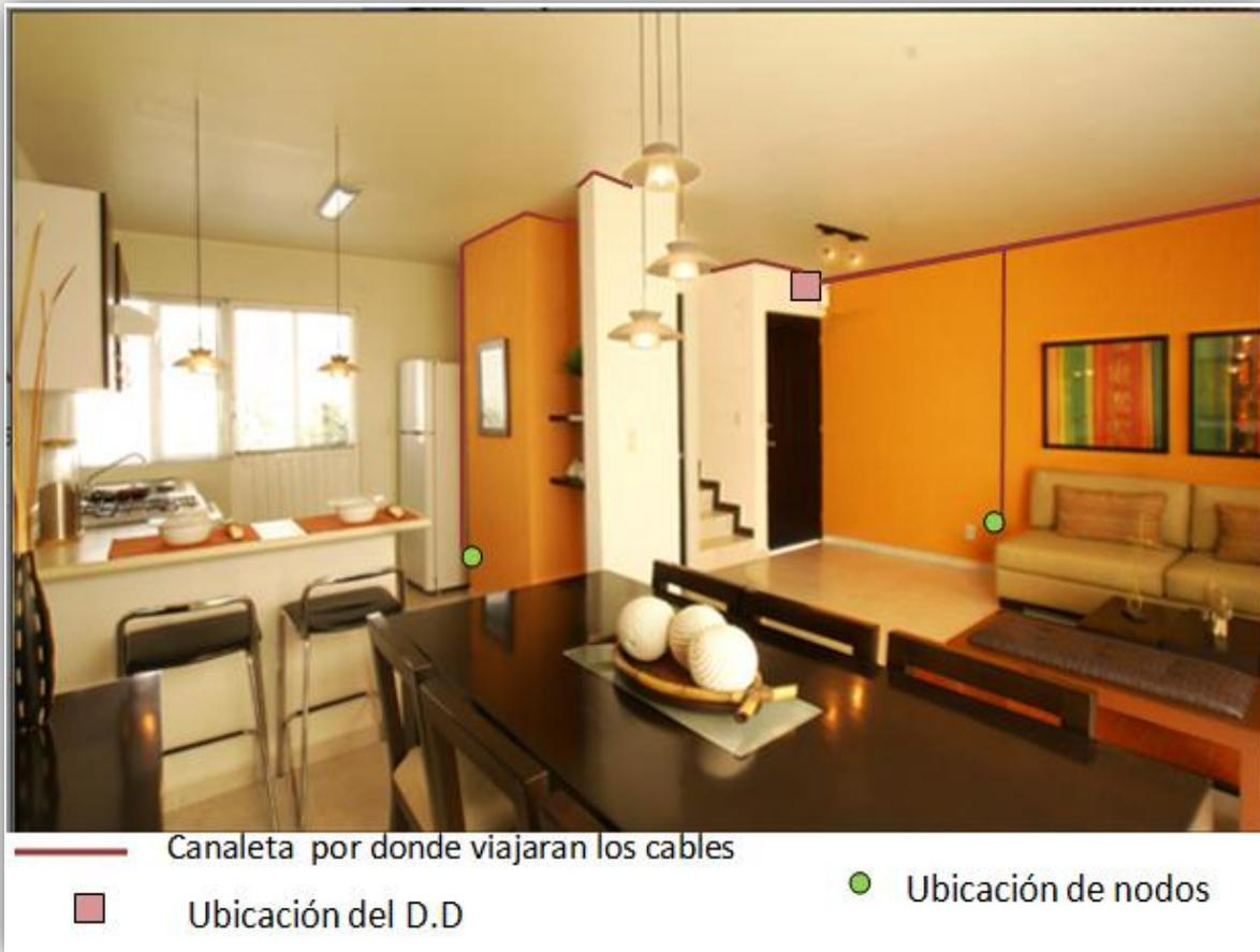
Figura 4.3.2.5 Ejemplo de la ruta por medio de canaleta y ubicación de dispositivos.
