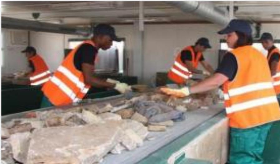
Figura 5.1 Separación en planta de RCyD.
