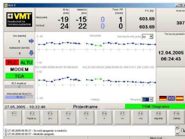
Diagrama TBM, en el gráfico anterior se muestran las desviaciones y tendencias para cada avance realizado por la TBM.
