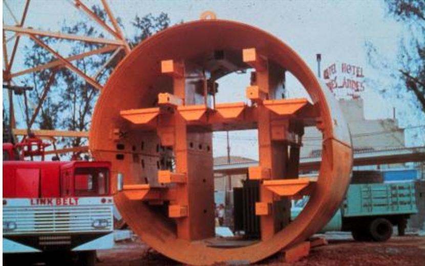
El extremo delantero de la camisa, donde se efectúa la excavación, es sumamente reforzado, generalmente con piezas fundidas para formar la cara de corte, y su rigidez se incrementa con anillos atiesadores. Su propósito principal es facilitar el avance uniforme y conducción del cuerpo del escudo cortando al frente, además de proporcionar una distribución de las importantes presiones inducidas.
