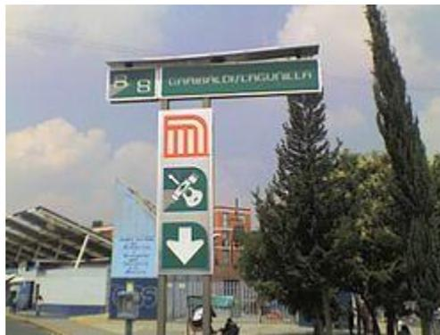
Señalamiento usual con iluminación LED y recarga de baterías mediante celdas solares.
