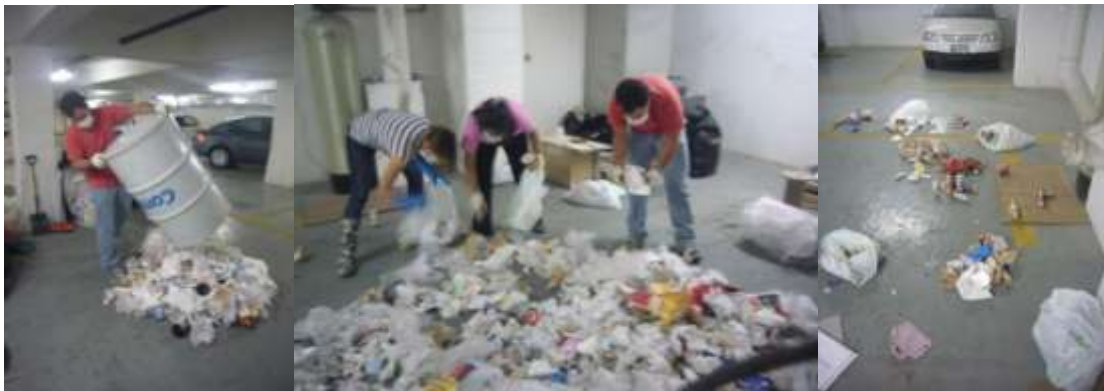
Figura 25. Vaciado y separación de subproductos.
