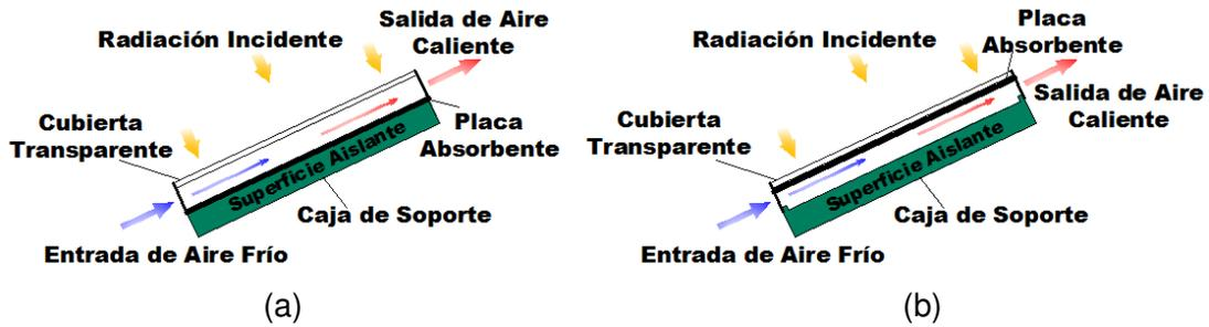
**Figura 3.4.-** Captador solar de placa plana con cubierta: (a) Con paso de aire superior; (b) Con paso de aire inferior
