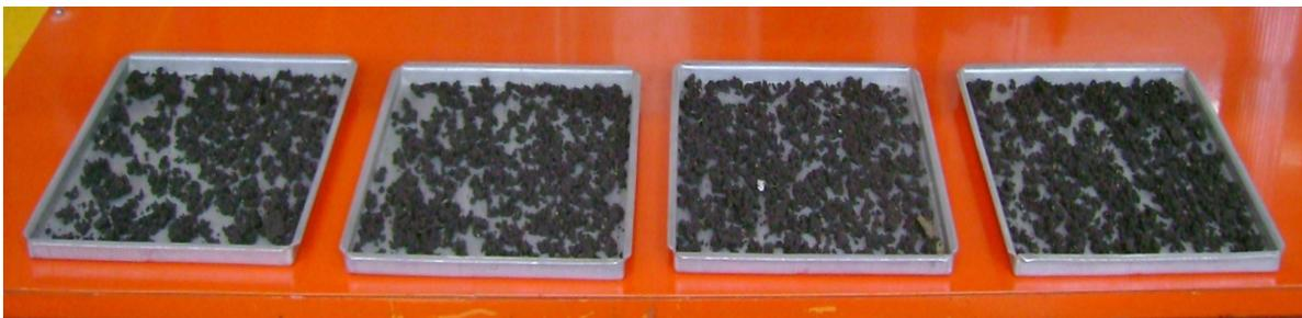
**Fotografía 5.2.-** Lodo residual después del proceso de secado
