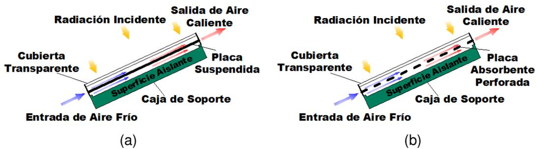
**Figura 3.5.-** (a) Captador solar de placa suspendida; (b) Captador solar de placa perforada
