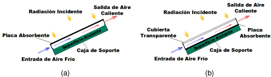
**Figura 3.3.-** Captador solar de placa plana: (a) Descubierta; (b) Cubierta
