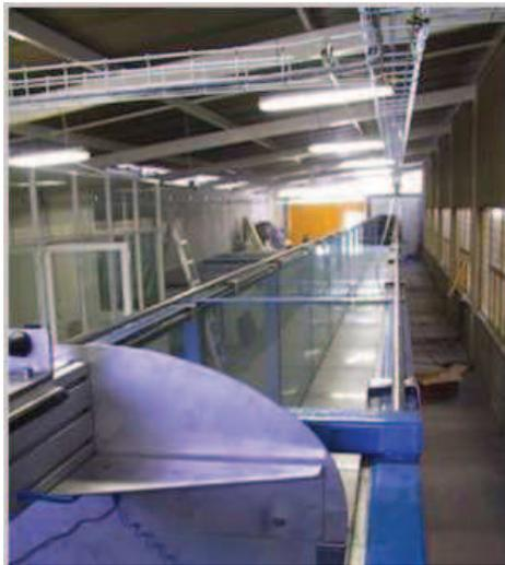
Figura 3-2 Canal de oleaje
