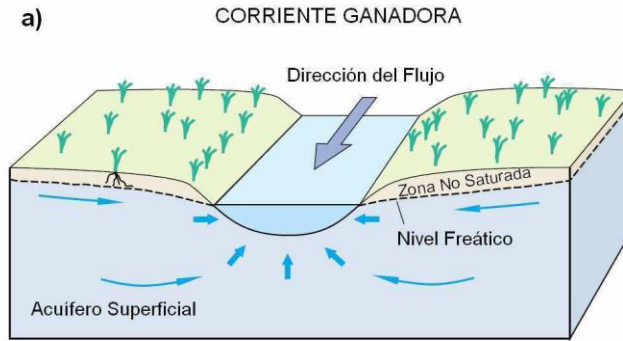
Ilustración 8. Esquema conceptual en un sistema río-acuífero de corrientes ganadoras
