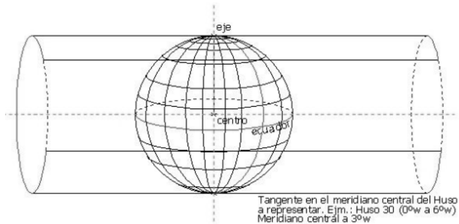
Fig. 2.14 Proyección cilíndrica transversal de mercator
