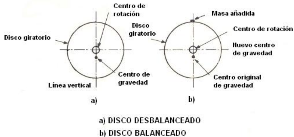
Figura N° 8. Procedimiento más simple de balanceo.
