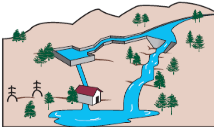
Figura 1. Esquema general de una central a hilo de agua.
