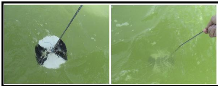
Figura 3.12 Determinación de turbiedad por medio del disco Secchi
