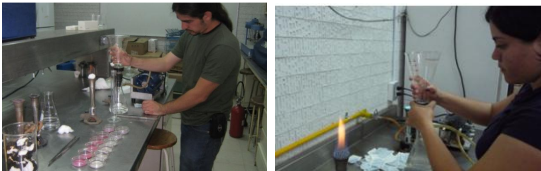
Figura 3.14 Método de filtración de membrana
