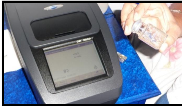
Figura 3.13 Manejo y operación de espectrofotómetro HACH DR 2800
