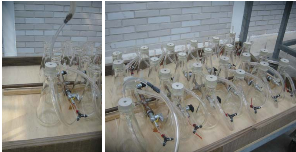
Figura 3.4 Sistema de extracción de lixiviados a) recuperación de lixiviados y b) línea de succión forzada
