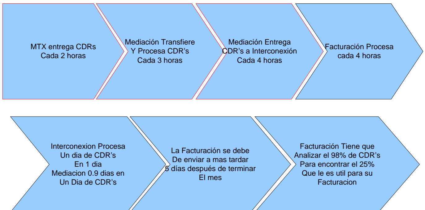
Figura 3.1.1 Proceso actual de transferencia de CDRs
